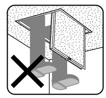
点検口の上にのらない。 点検口の変形・けがの原因と 点検口の変形・けがの原因と 点検口の変形・けがの原因と なります。
