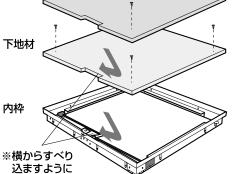
天井下地材を天井材受けに皿木ネジで固定 してください。次に天井仕上材を接着固定し 内ブタを仕上げてください。
