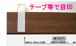
◆物差しを<縦枠と上枠>の2面に当てながら ⇒ 物差しの100mm位置に合わせて、上枠にテープ等で目印を付ける ⇒ 物差しを外す
