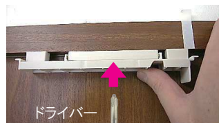
◆工具の穴にドライバーを挿入 ⇒ そのままドライバーで少し押し込めば、工具からベースが外れて上枠にくく仮固定>されます。
